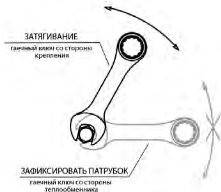
Рис. 5. Подключение к системе подачи теплоносителя
